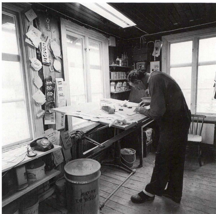
Bengt Lennartsson, Emaljfabriken Svea, borstar fram text på en skylt. Foto: Jan Berg
