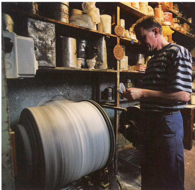
Emaljen mals under flera timmar för att få rätt konsistens. Vid sidan sidan står Lennart Hermansson, Sprakareds Emaljverk. Foto: Jan Berg
