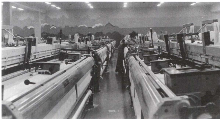
Interiör från Kungsfors fabrik. År 1977 färdigställdes ett nytt enplansväveri för 192 skyttelösa vävmaskiner.
