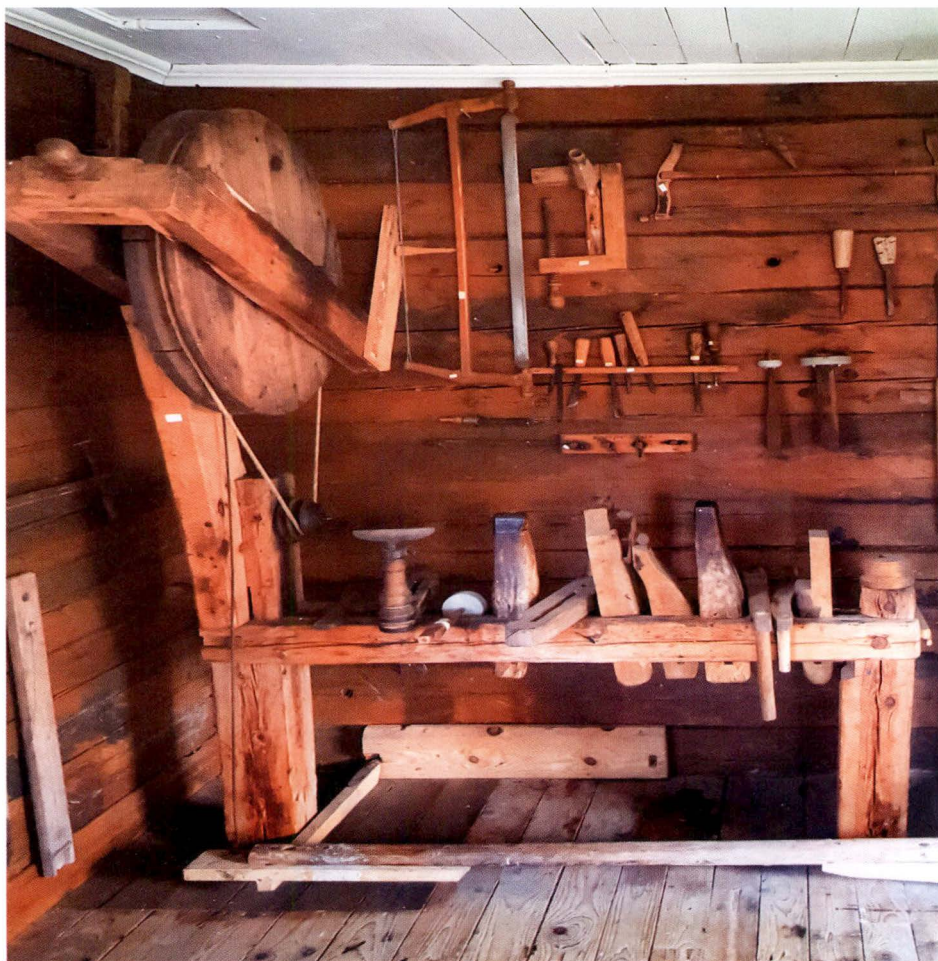
Svarven som träsnidarna använde till all svarvning. Den drevs genom att man trampade den på samma sätt som man trampar en spinnrock. Foto: Mariann Andersson Norrman
