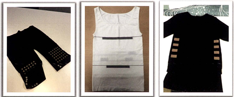
Fig 3. Fysiologiska smarta sensoriska textilier. 1 EMG, elektromyografi. 2 Andningsmonitorering. 3 EKG, elektrokardiografi.
