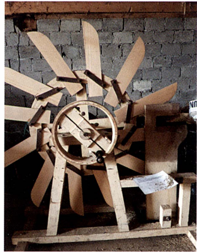
Det går snabbt att bråka och skäkta linet i dessa maskiner. Foto: Hillevi Skoglund
