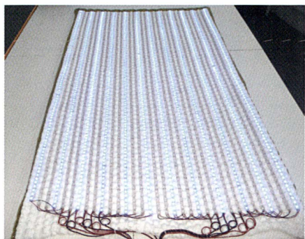
Fig 5 En ljusbehandlingsfilt för behandling av Crigler- Najjar sjukdom utvecklade i Borås. Patienter med Crigler-Najjars sjukdom saknar förmåga att bryta ner ämnet bilirubin - en nedbrytningssubstans i naturliga omsättningen av röda blodkroppar. Höga bilirubinhalter leder inte bara till att huden och ögonvitorna antar en gulaktig ton, alltför höga halter av ämnet kan orsaka hjärnskador; dövhet, oförmåga att koordinera kroppsrörelser, krampanfall, muskelspänningar och vara livshotande.
