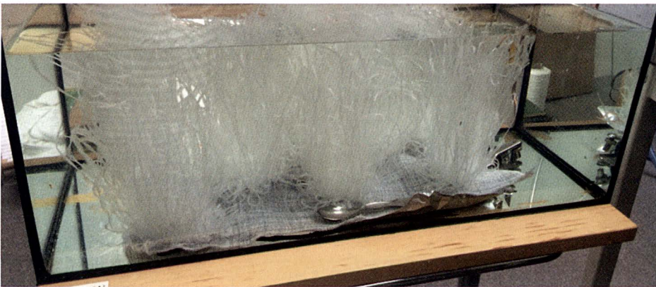
Fig 7. Prototyp till en avancerad geotextil. Medelst textila processen tuftning har dungar av konstgjort ålgräs gjorts på en matta (grå i akvariet). Ålgräs ( Zostera marina L.) utgör en av jordens viktigaste biotoper - på samma nivå som regnskogar eller cirkumpolära barrskogar - och finns runt om i världen från tropikerna till polcirkeln i grunda kustnära salt- och bräckvatten. Biotopen ger skydd och föda för ett brett spektrum av växt- och djurarter, inklusive kommersiellt viktiga fiskar - vilket resulterar i en ofta mycket hög grad av biologisk mångfald. Ångarnas tätpackade morfologi är viktig för sedimentavsättning och därmed vattenrening av partiklar. Dessutom är nätet av rhizom och rötter en viktig stabiliseringsfaktor för det ofta leriga och sandiga underliggande underlaget och därigenom för att motverka kusterosion.
